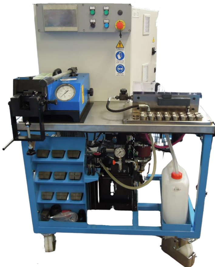
Figura 153 Unità di collaudo per prove distruttive e di tenuta in pressione del tubo
