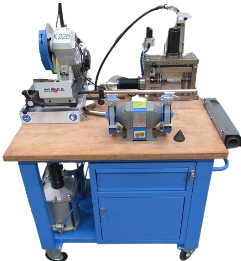
Figura 14 Unità esterna per testare la qualità di saldatura di tubi in acciaio inossidabile
