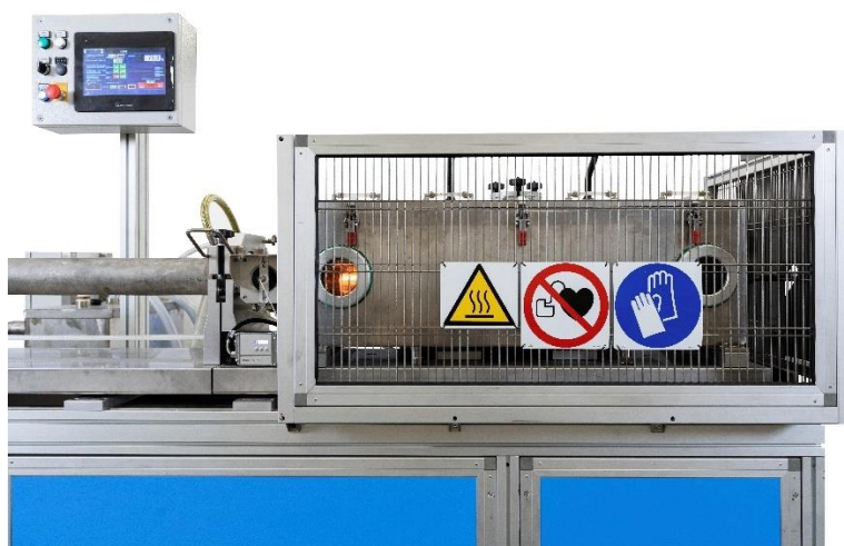
Figura 8 Forno a induzione per il trattamento termico
