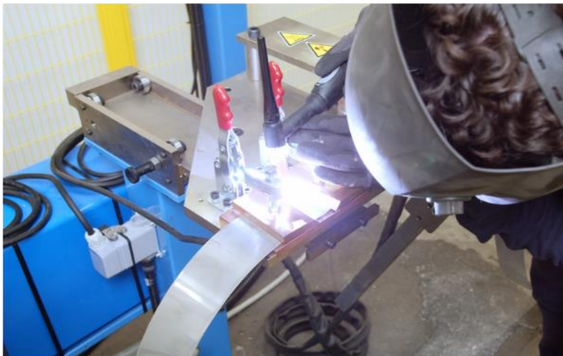
Figura 2 Banco di giunzione nastro
