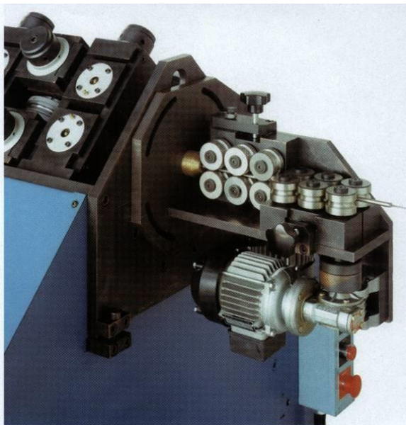
Mod. 143/00.200000 Raddrizzatura per diametro 6-8,5 mm
